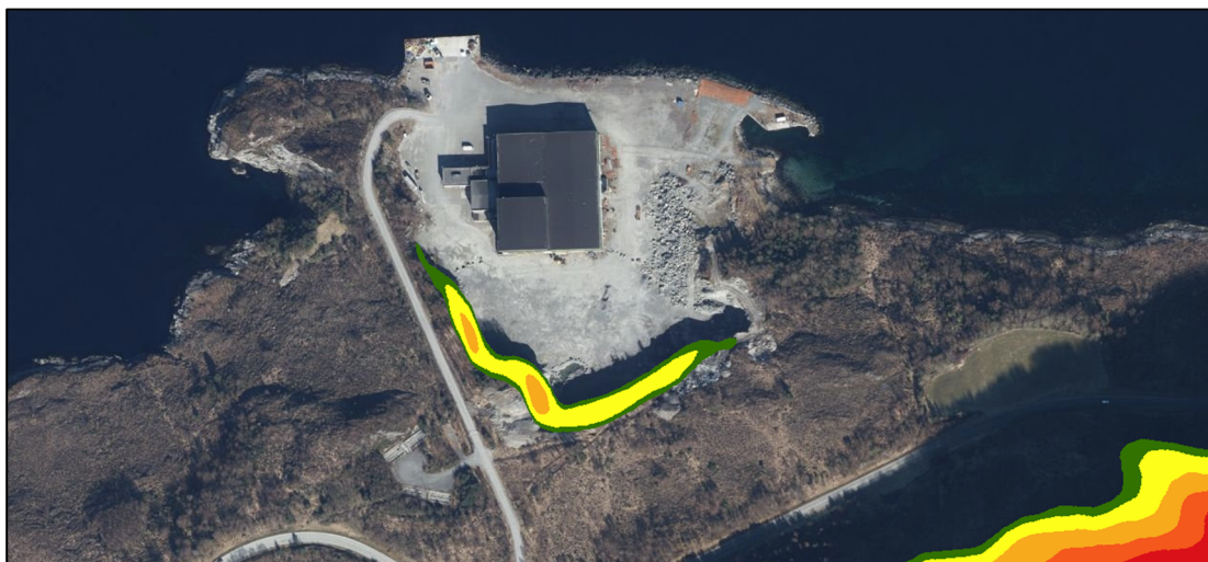
Figur 23: Bratthet snøskred syner høgaste skjeringane i dagens massetak. (NVE)
