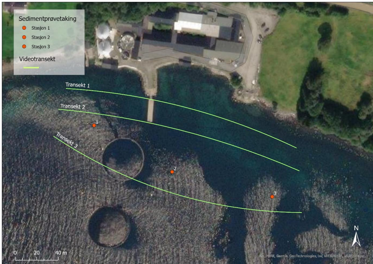
Figur 2.2: Kart over området ved lokalitet Sighaug med plassering av stasjoner for sedimentprøvetaking (st.1-3) og omtrentlig linjer for videotransekt som ble gjennomført av dykkere. Kartdata: Bakgrunnskart fra ArcGIS Pro, Datum WGS84.
