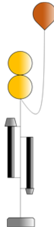
Figur 4 Prinsippskisse av strømmålerigg. AquaDopp Profiler måler oppover i vannsøylen, med ekstra punktmålere som peker nedover. Modifisert skisse fra NS 9424-1:1999. NB: I denne undersøkelsen ble det brukt to punktmålere.
