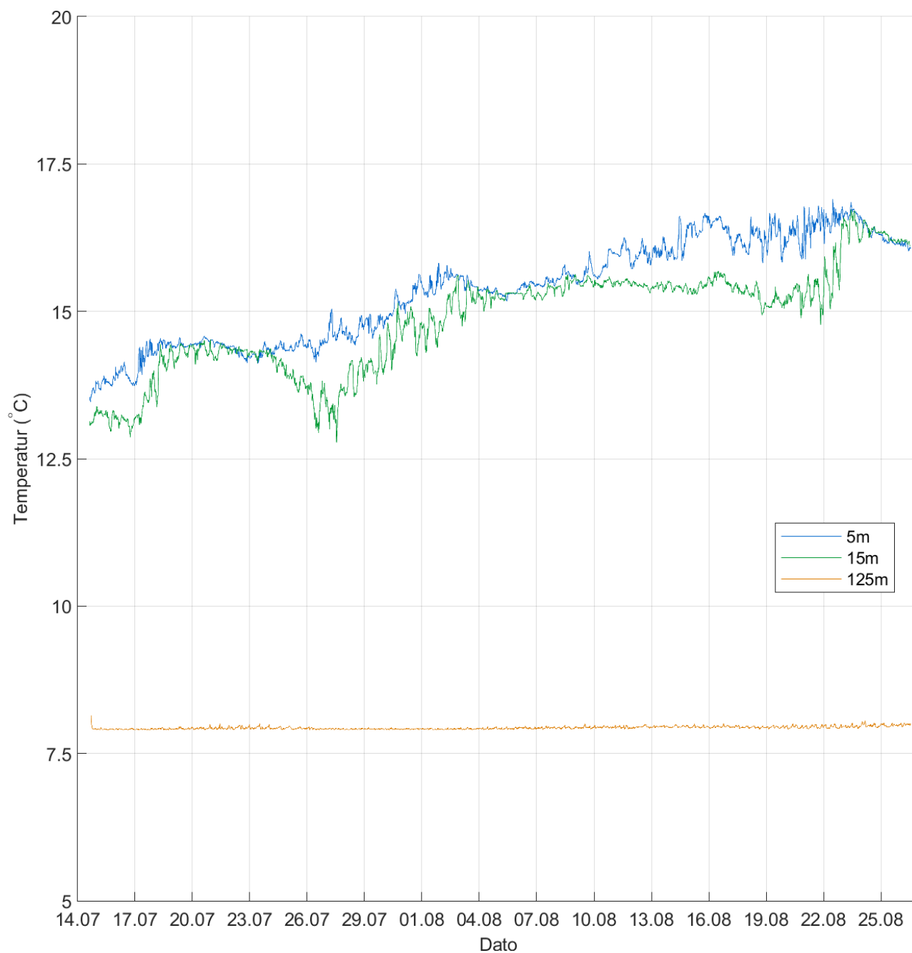
Figur 4.8.1. Tidsdiagram av temperatur på 5m, 15m og instrumentdyp (125m). Temperatur er indikert på stående akse og tid på liggende akse.
